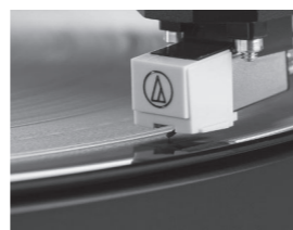
La pointe de lecture est positionnée au-dessus de la rainure d'entrée juste avant la lecture
