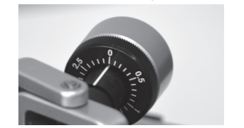
Skala zeigt nach der Einstellung auf 3,0 g null an
