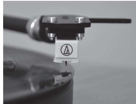
Tonabnehmernadel über dem Einlaufbereich der Schallplatte in Stellung gebracht, kurz bevor die Wiedergabe beginnt
