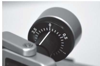
Scala impostata a zero dopo il bilanciamento del braccio
