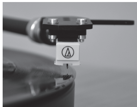
Puntina posizionata sopra il solco di avvio appena prima della riproduzione
