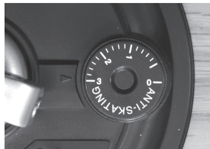
Impostazione del controllo anti-skating a 3,0 grammi
