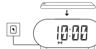
Ihr Radiowecker hat einen USB-Port, der zum Laden von Geräten verwendet werden kann. Schließen Sie Ihr Gerät am USB-Ladeanschluss auf der Rückseite des Radioweckers an.
