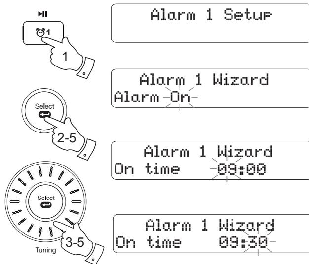
Hvis radioen er blevet indstillet til at bruge 12-timers urformat, vil du også kunne finde en valgmulighed til indstilling af alarmtidspunkter til AM eller PM.
