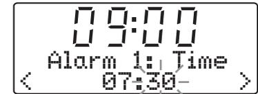
8. Drücken Sie **Senderwahl aufwärts** oder **abwärts** zur Auswahl der Alarmminuten, dann drücken Sie **Select** zur Eingabe der Minuten. „Alarm: Mode“ wird auf der oberen Textzeile angezeigt.
