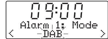
10. Drücken Sie **Select** zur Auswahl des Alarmmodus. „Alarm: Day“ wird auf der oberen Textzeile angezeigt.
