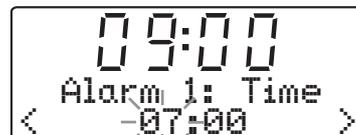
7. Drücken Sie **Senderwahl aufwärts** oder **abwärts** zur Auswahl der Alarmstunden, dann drücken Sie **Select** zur Eingabe der Stunden. Die Alarmminuten blinken.
